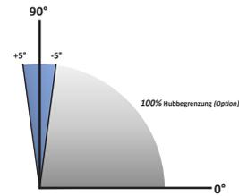
Die Endlage in Schaltstellung kann über die Einstellschrauben im Antriebsgehäuse um +/-5° feinjustiert werden.
