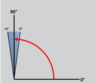
Durch Verstellen der Endlageneinstellschrauben "A" lassen sich beide Endlagen zur Feinjustage der Armaturenendstellung um +/- 5° verstellen. Die jeweilige Einstellposition wird durch Festziehen der Kontermutter gesichert.
